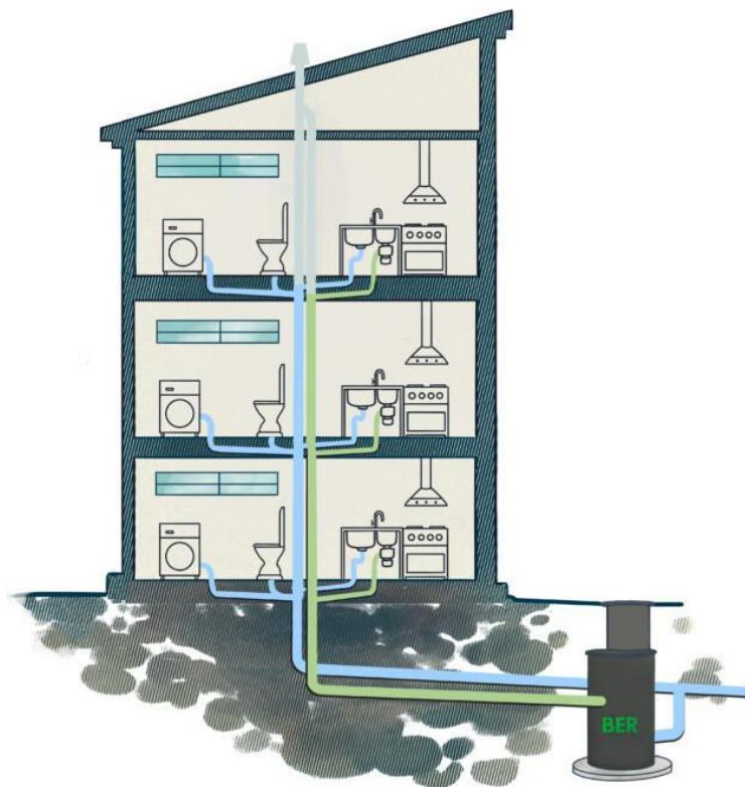
Kuva 3. Havainnekuvassa on esitetty sinisellä jätevesiviemäri ja vihreällä biojäteviemäri.
